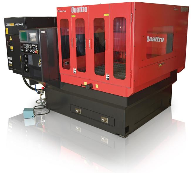
Diese Bauweise ermöglicht die Verarbeitung von Materialien auf sehr kleinem Raum, da dabei lediglich der Schneidkopf bewegt werden muss. Der AF1000i-C/AF2000i-C LU2.5 Oscillator erzeugt einen hochwertigen Lichtstrahl mit minimaler Fluktuation. Der Abstand zwischen der Düse und dem Material wird automatisch von ei-
