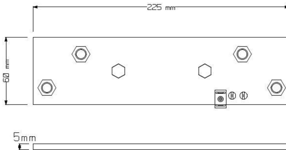
Bild einer Sammelschiene 5 Pol.
