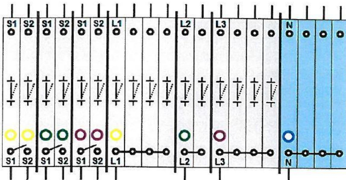
Bild eines Prüfklemmsatzes PK VDEW
