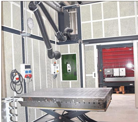
Die Schweißkabinen haben verstellbare Tische, eine direkte Rauchabsaugung und Schallschutzkabinen.
