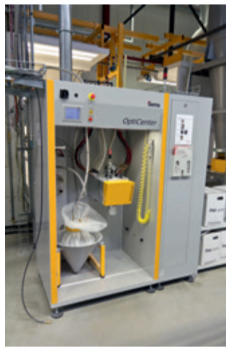
Das Pulverzentrum „OptiCenter OC2“ sorgt für schnelle Farbwechsel.
